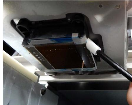
(4) Essuyez la partie en résine entre la surface des buses de la tête d'impression et la protection de buses.
