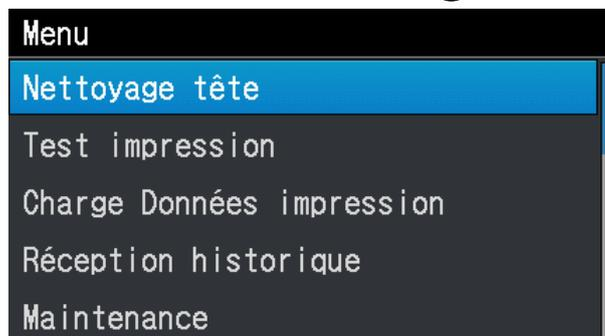
(3) En appuyant sur
