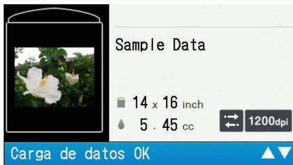
La carga de los datos de impresión finalizará cuando el botón de impresión deje de parpadear y permanezca iluminado; sonará una señal acústica.
