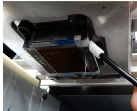
(4) Wischen Sie den Harzteil zwischen der Druckkopf-Düsenoberfläche und dem Düsenenschutz.
