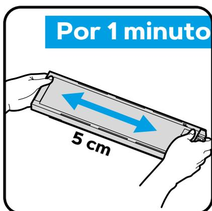
Retire o cartucho de tinta branca da impressora. Agite o cartucho horizontalmente 100 vezes lado a lado para agitar a tinta branca.
