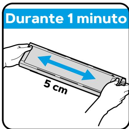
Extraiga el cartucho de tinta blanca de la impresora. Agítelo horizontalmente unas 100 veces de lado a lado para remover la tinta blanca.
