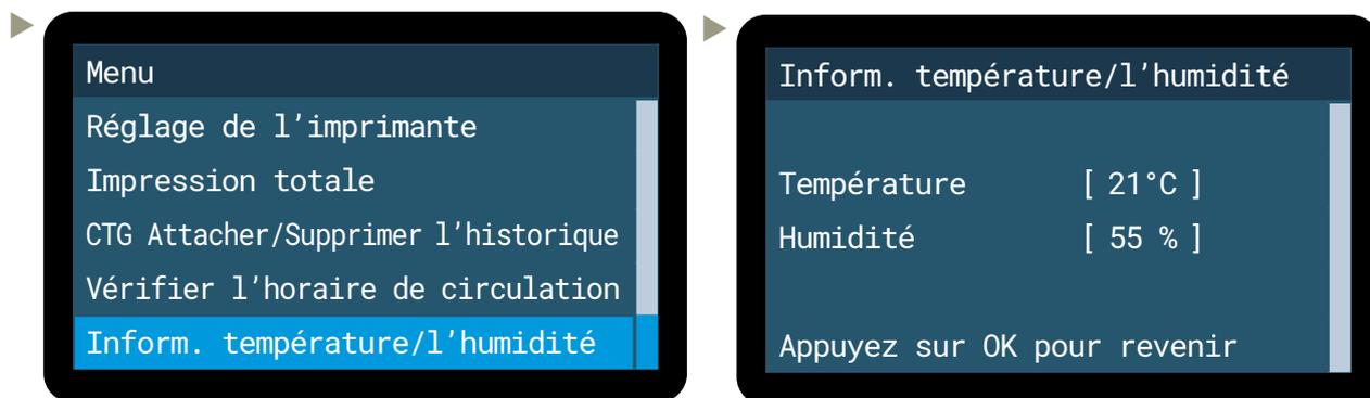
**Si la température est trop fraîche :** L'imprimante passera automatiquement en « Mode basse température » et réduira la vitesse. Augmentez la température de l'environnement de l'imprimante.
