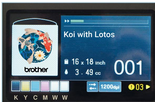
Das Display zeigt die aktuelle Druckdatei mit der verwendeten Druckplatte und den ungefähren Tintenverbrauch, sowie die Anzahl der erstellten Drucke an. In der unteren linken Ecke wird der Tintenstand angezeigt.
