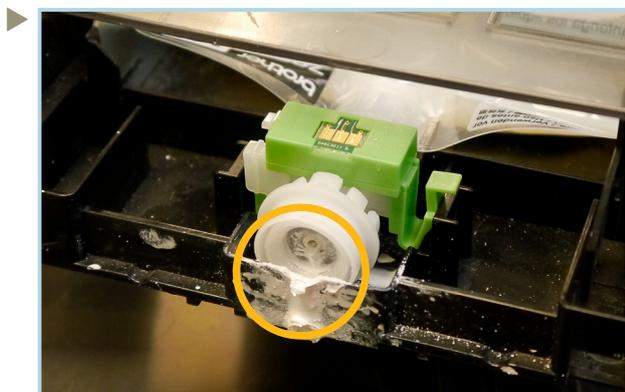
Entfernen Sie trockene Tintenreste mit einer Pinzette.
