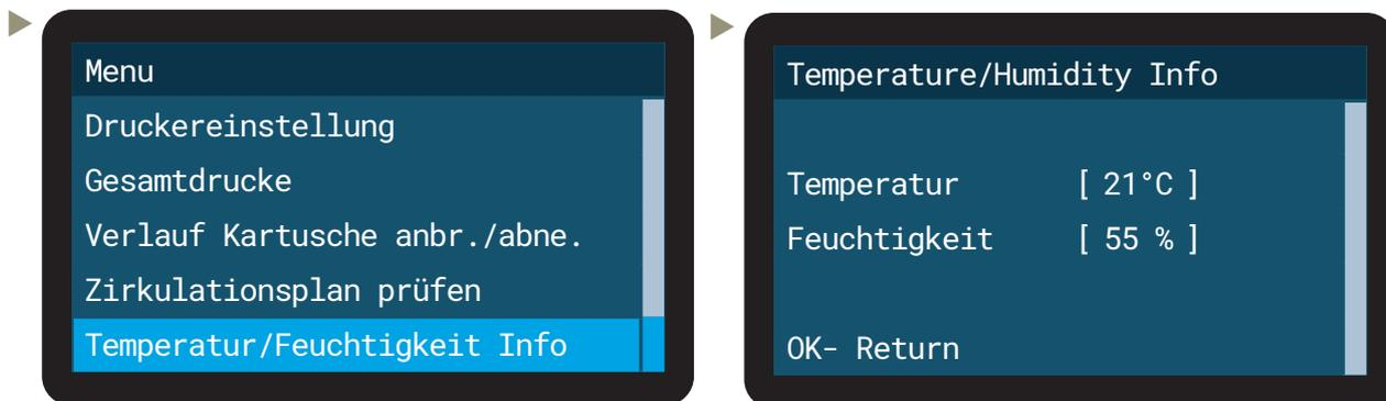
**Wenn die Temperatur zu niedrig ist:** Der Drucker schaltet automatisch in den „Low-Temp-Modus“ (reduziert die Druck-Geschwindigkeit). Erhöhen Sie bitte die Umgebungstemperatur des Druckers.
