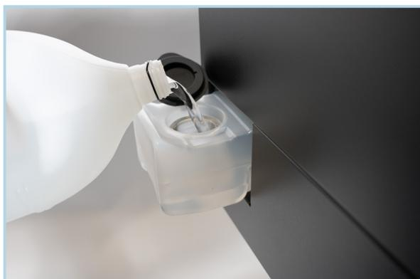
Ziehen Sie an der linken Seite des Druckers den „Cleaning Solution“-Tank heraus und befüllen ihn mit BROTHER-Cleaning Solution. Achten Sie darauf, dass die „Full“-Linie nicht überschritten wird.
