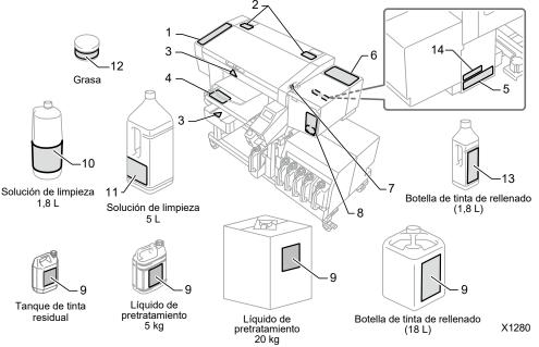
Esta impresora tiene adheridas las siguientes etiquetas de aviso. Siga las precauciones indicadas en cada etiqueta de aviso para el trabajo a realizar. Si la etiqueta se despega o se vuelve ilegible, póngase en contacto con el distribuidor.
