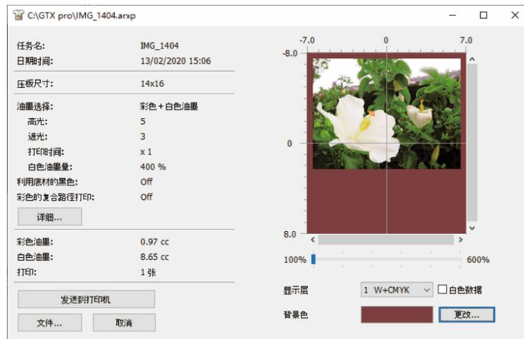
(4) 压板多次进出打印的数据时，通过选择显示层，可以确认各层的打印数据。从[显示层]中选择要显示的层。
