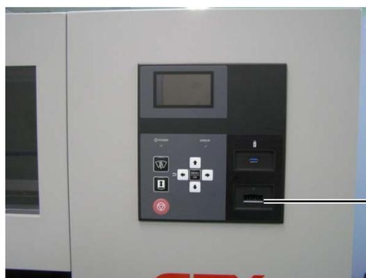
Slot per inserimento dello stick IC
