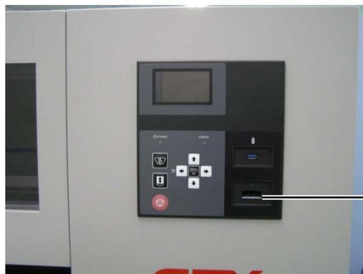
Slot per inserimento dello stick IC
