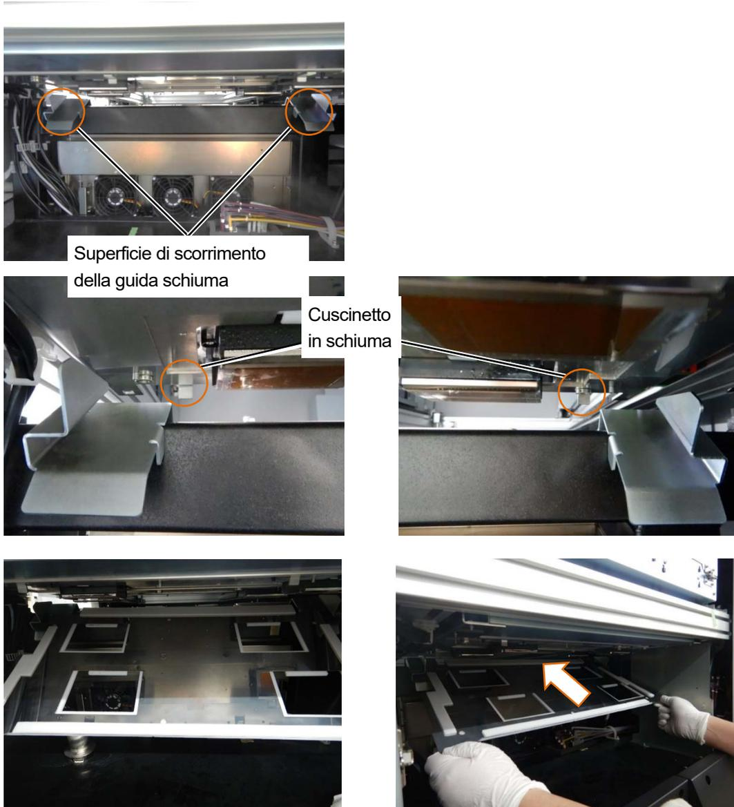
(14) Ruotare e montare la schiuma sul magnete sul carrello.
