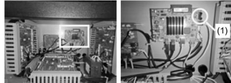
2) Retire la batería de litio (1) tirando del soporte en la dirección de la flecha.
