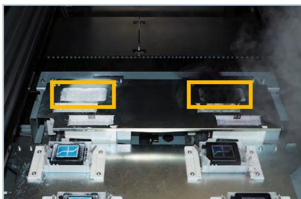
Posizione delle spugne di scarico.
