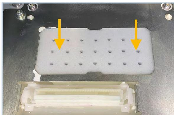
Dopo aver sostituito la prima spugna di scarico, pulire i guanti con un panno, poi sostituire la seconda spugna di scarico.
