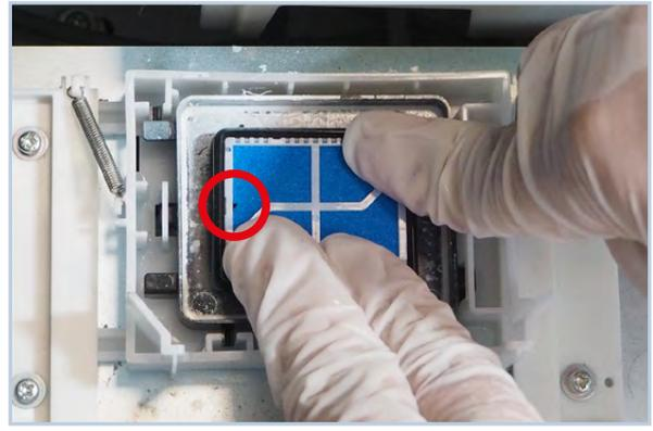
Inserire un nuovo capping. **Prestare attenzione a installarlo con il foro piccolo sul lato sinistro del capping.**
