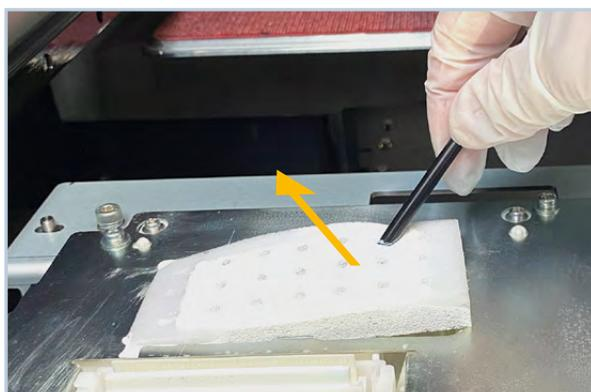
Rimuovere la vecchia spugna di scarico utilizzando un panno per evitare di far gocciolare inchiostro nella **GTX600 NB**.
