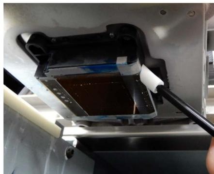
(4) Pulire la parte in resina tra la superficie ugello della testa di stampa e la protezione ugelli.
