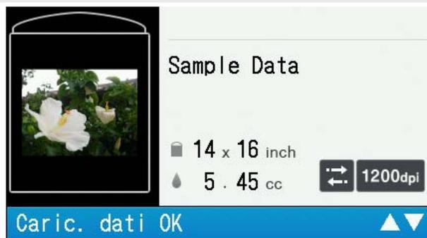
Il caricamento dei dati di stampa sarà stato completato quando il pulsante di stampa smette di lampeggiare e rimane acceso, mentre il cicalino elettrico suona.
