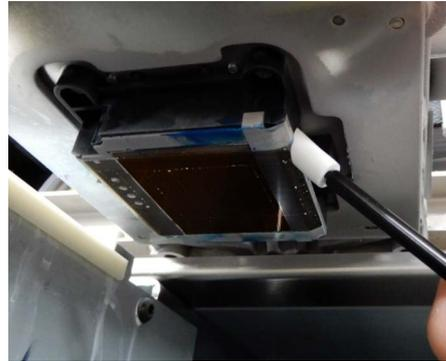
(4) Limpie la pieza de resina entre la superficie de la boquilla del cabezal de impresión y la protección de boquilla.
