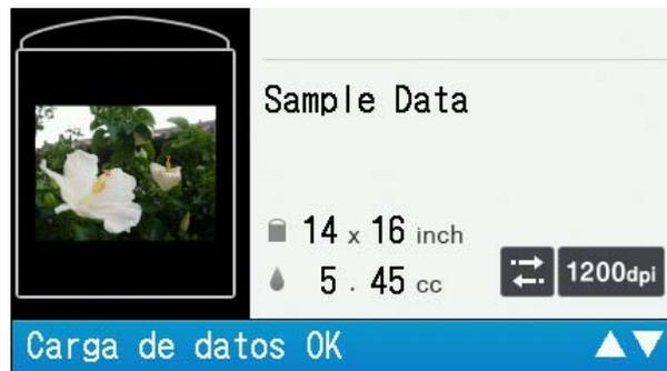
La carga de los datos de impresión finalizará cuando el botón de impresión deje de parpadear y permanezca iluminado; sonará una señal acústica.
